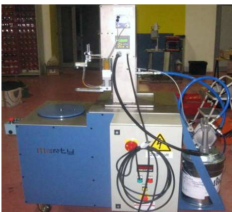
Dosieranlage mit Membranpumpe und Rundtaktisch.
