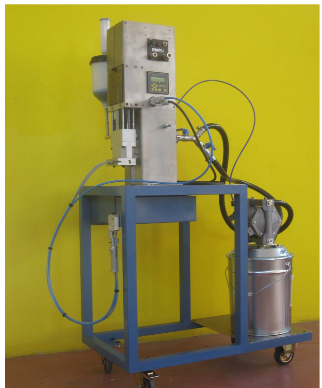
Dosieranlage mit Membranpumpe für Harze und 2 Litertank für Härter.
